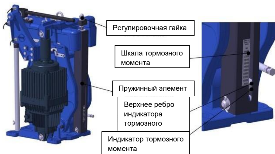
Рис. 6: Установка тормозного момента на примере USB3
